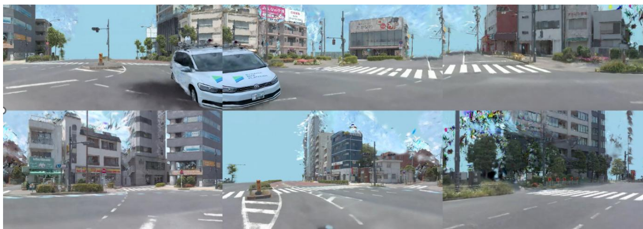
自車搭載カメラ視点の再現と対向車シナリオ追加の例
