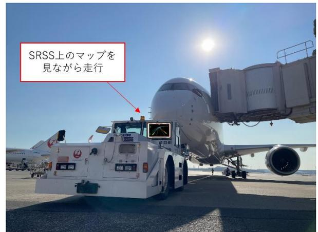
(左)空港内高精度 3 次元地図データイメージ (右)航空機のプッシュバック時の SRSS 使用イメージ
