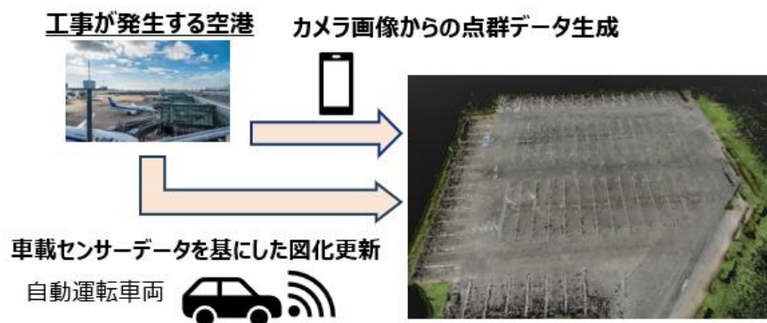
車載センサーやカメラ画像を活用した地図更新プロセスのイメージ
